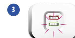
LED-urile ROȘU și VERDE doar în modul AUTO arată că există output de la receptor (datele se prelucrăză). Device-ul la care receptorul este conectat, va fi comutat pe poziția ON.
