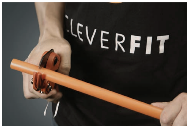
Tăierea corectă a conductei cu o foarfecă
