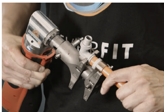
Tragerea inelului peste fitting
