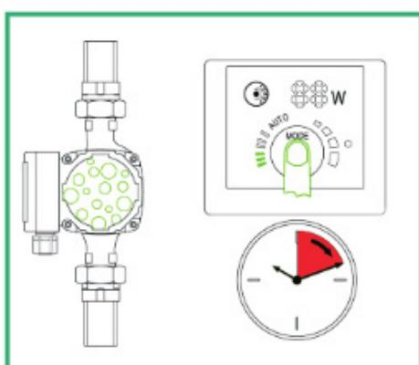
Pompele seria GPA sunt echipate cu funcția auto-ventilare. Înainte de pornire este absolut necesar să aerisiți sistemul. Aerul în motorul pompei poate cauza zgomot. După ce pompa a fost pusă în funcțiune, după câteva minute de funcționare, zgomotul dispare.
