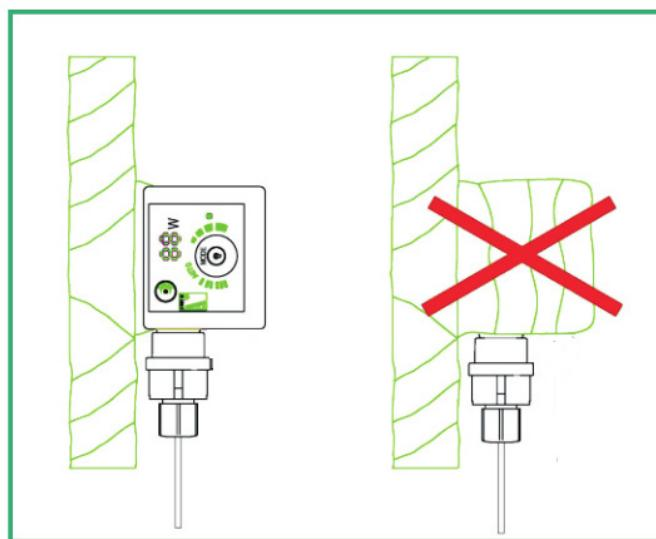
Notă : Pentru a reduce pierderile de căldură, pompa trebuie izolată aşa cum este prezentat în figura de mai sus. Nu acoperiți cu izolație capacul conexiunilor electrice și nici panoul de control.
