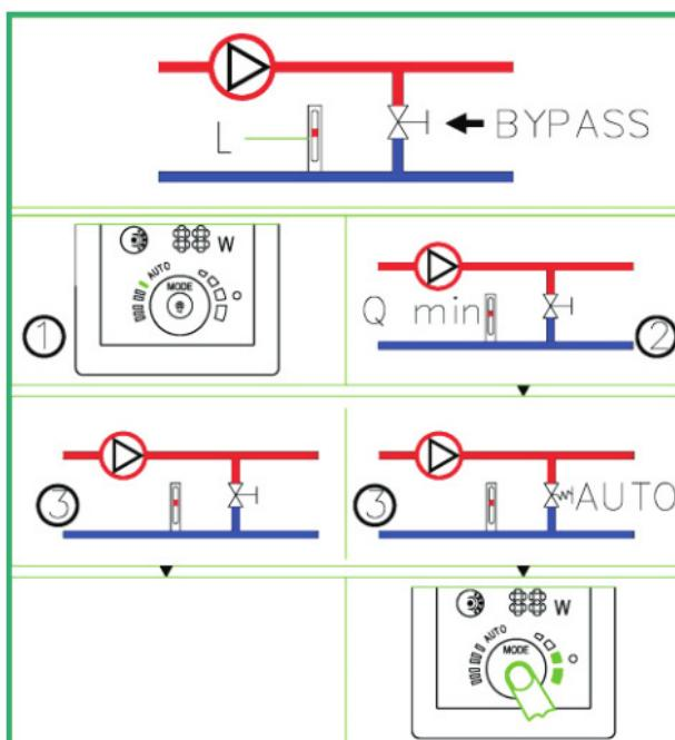
Scopul valvei de bypass: când toate valvele și/ sau valvele de citrire temperatură de pe radiator sau de pe circuitul de încălzire în pardoaseală sunt închise aceasta poate asigura că agentul termic poate fi distribuit din cazan.
