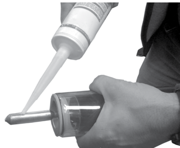
Adăugați rășina termoconductoare pe condensatorul țevii heat-pipe.
